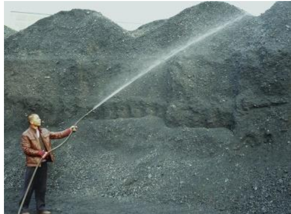
洒水降尘实例照片
