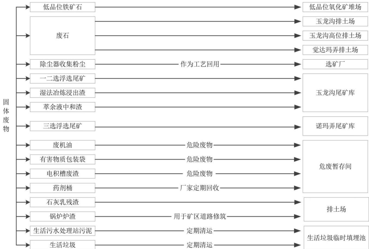
图 2.9-3 全厂固废处置措施及去向示意图
